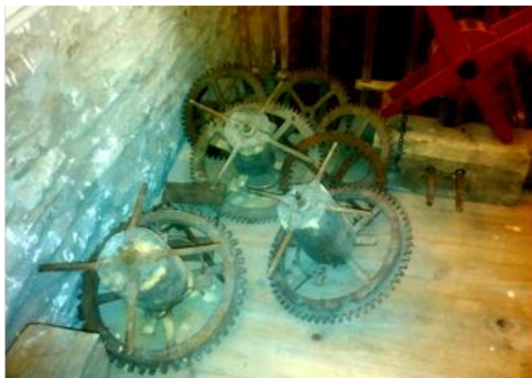
Fig. 21. Engranatges e d'auti rèstes der antic relòtge de campanau
